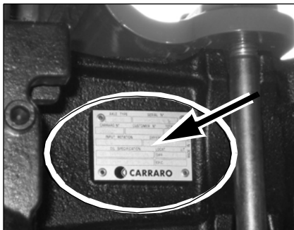
Abb. 11: Typenschild der Hinterachse und Getriebe
