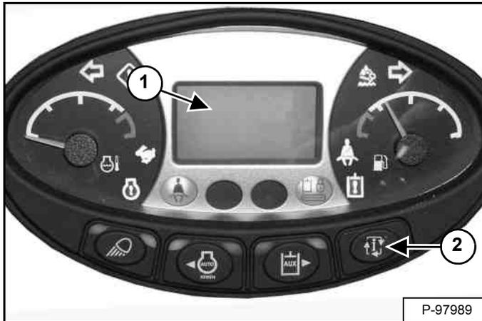
Die Informationstaste (2) drücken, bis auf der Datenanzeige (1) [Abbildung 326] die Service Codes angezeigt werden. Wenn mehr als ein SERVICE CODE vorhanden ist, werden die Codes abgerollt.
