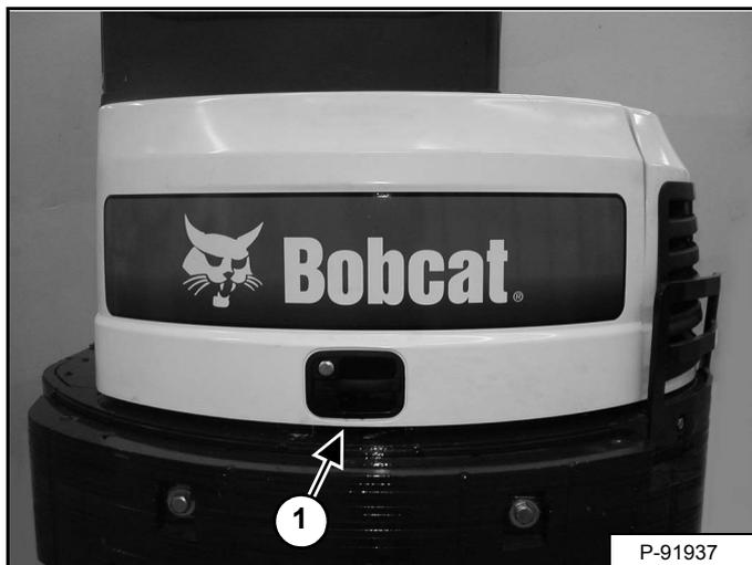
Dieser Bagger kann über ein Fahralarmsystem verfügen. Der Fahralarm (1) [Abbildung 38] befindet sich im hinteren Teil des Baggers.
