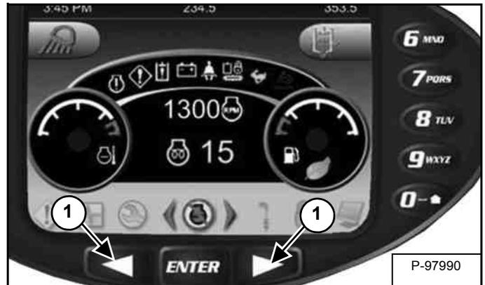
Den Motor abstellen und den Schlüsselschalter auf EIN drehen. Eine der beiden Navigationstasten (1) [Abbildung 56] (Deluxe-Instrumententafel) drücken, bis der obige Bildschirm angezeigt wird.
