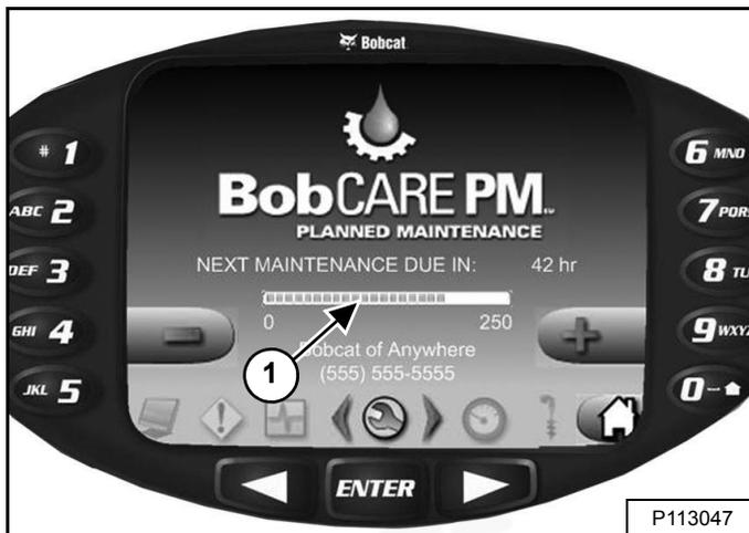
Die Deluxe-Instrumententafel (sofern vorhanden) zeigt einen Balken (1) [Abbildung 333] an, der die verbleibende Zeit bis zum nächsten Wartungstermin anzeigt. Der Balken leuchtet rot, wenn der Wartungstermin überfällig ist. Die Meldung NEXT MAINTENANCE DUE (NÄCHSTER WARTUNGSTERMIN FÄLLIG) ändert sich dann in MAINTENANCE PAST DUE (WARTUNGSTERMIN ÜBERFÄLLIG) und zeigt die Überschreitung in Stunden an.
