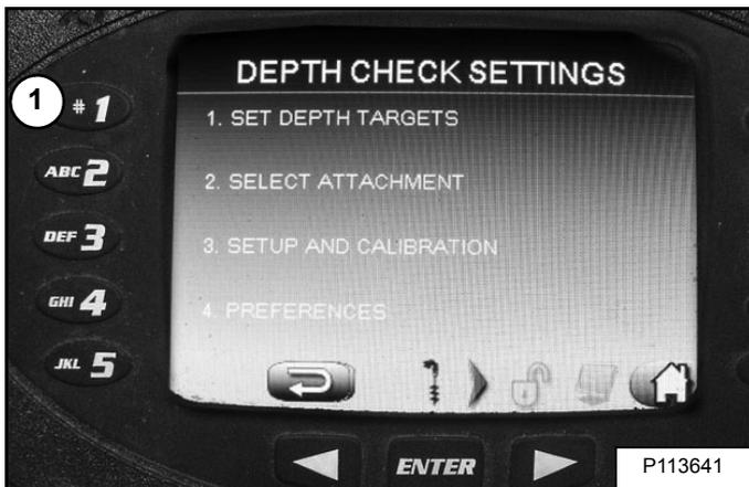
Die Taste [SET DEPTH TARGETS] (1) [Abbildung 208] zum Festlegen von Zieltiefen drücken, um zum nächsten Bildschirm zu wechseln [Abbildung 209].
