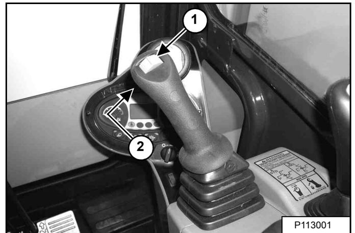
Den Schalter (1) [Abbildung 54] am rechten Steuerhebel nach rechts bewegen, um die Kupplungsbuchse mit Hydraulikfluss zu versorgen. Den Schalter nach links bewegen, um den Kupplungsstecker mit Hydraulikfluss zu versorgen. Wird der Schalter nur bis zur Hälfte nach rechts oder links bewegt, arbeiten die Zusatzhydraulikfunktionen etwa mit halber Geschwindigkeit.
