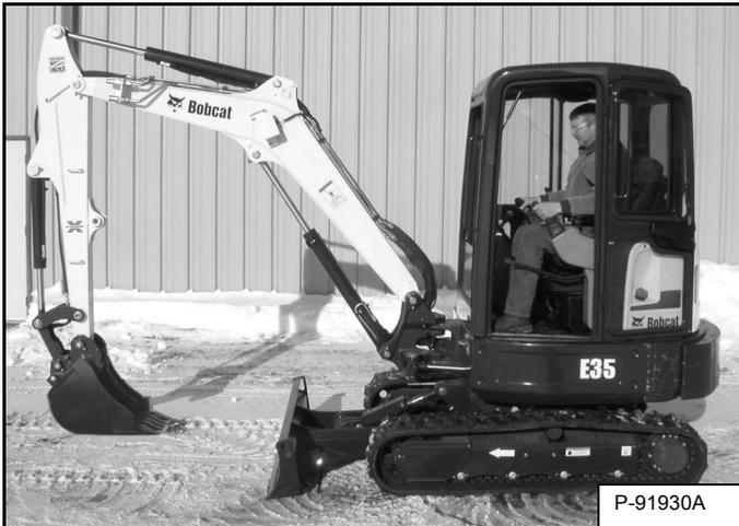
Maschine auf waagrechtem Untergrund anhalten. Das Arbeitsgerät und den Planierschild auf Bodenhöhe absenken **[Abbildung 91]**.
