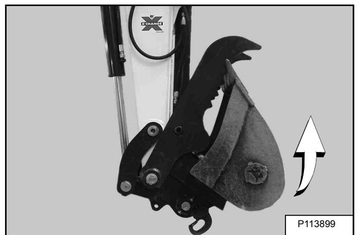
Den rechten Joystick (1) [Abbildung 109] nach links bewegen (OUT) und den Schnellwechsler (1) [Abbildung 112] vollständig in Richtung Kabine einkippen.
