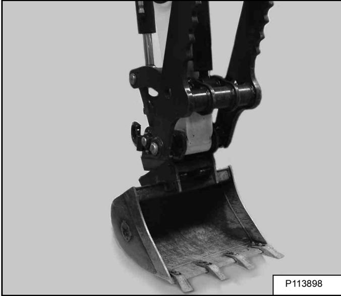
Den Schnellwechsler bei leicht vom Boden angehobenem Anbaugerät zurückrollen, bis er sich vom Anbaugerät löst [Abbildung 131].
