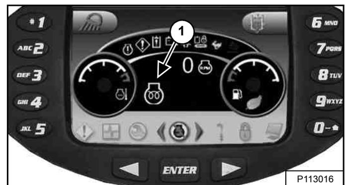
Wenn vorgeglüht werden muss, werden die Glühkerzen automatisch in Gang gesetzt und das Vorglühsymbol (1) [Abbildung 89] wird auf der Datenanzeige angezeigt.
