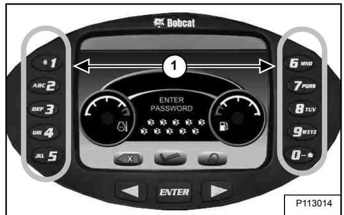
Den Zündschalter (2) [Abbildung 87] in die Position EIN drehen. Die Meldung [ENTER PASSWORD] (PASSWORT EINGEBEN) erscheint auf dem Display, wenn die Deluxe-Instrumententafel gesperrt ist. (Ist sie nicht gesperrt, können Sie den Motor ohne Passwort mit dem Zündschalter anlassen.)
