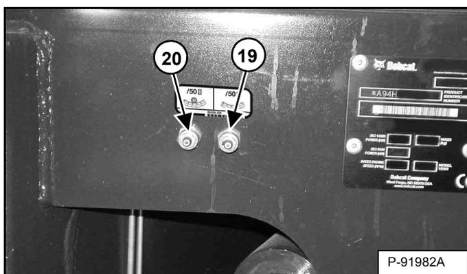
Die folgenden Positionen am Hydraulikbagger **ALLE 50 BETRIEBSSTUNDEN** abschmieren.
