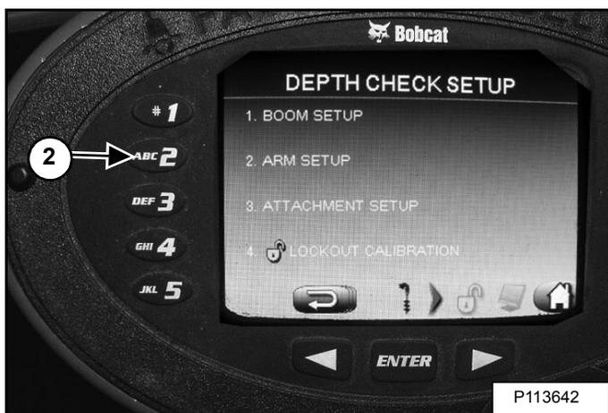
Die zweite Person bleibt in der Kabine und drückt die Taste [ARM SETUP] (2) [Abbildung 178] zur Einrichtung des Löffelstiels.
