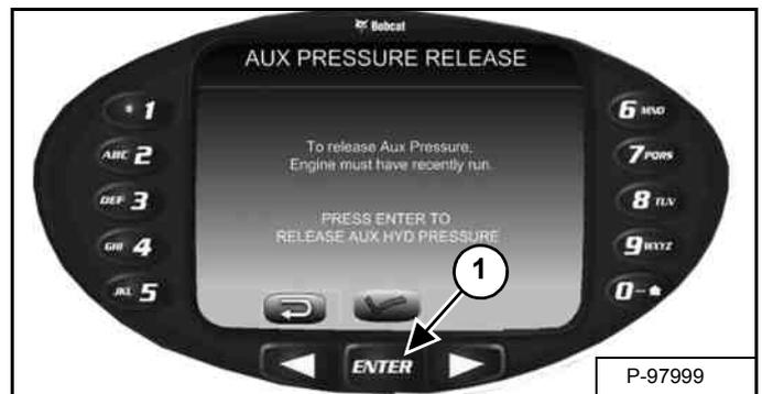
Die Taste [ENTER] (1) drücken [Abbildung 57] um den Hydraulikdruck im Bagger abzubauen. Ein Sanduhrsymbol erscheint und sobald der Druck abgebaut wurde, wird auf dem Bildschirm *Zusatzhydraulikdruck abgebaut* angezeigt.
