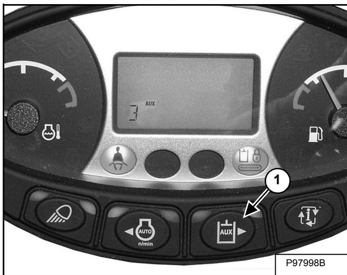
Bei deaktivierter Zusatzhydraulik die Taste AUX HYD (1) [Abbildung 55] drücken und dann den Schalter (1) [Abbildung 54] mehrmals nach rechts und links bewegen.
