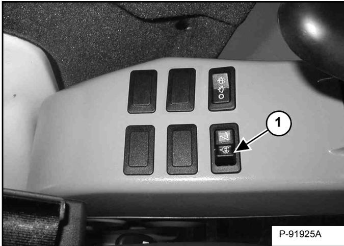
Die Taste AUX HYD (1) [Abbildung 58] (sofern vorhanden) nach rechts in die Position für die sekundäre Zusatzhydraulik schieben.
