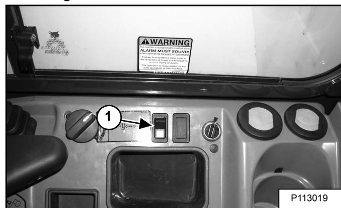
Beide Fahrsteuerhebel leicht nach vorne bewegen (bis der Bagger sich leicht nach vorne bewegt) und dann den Schalter zur Unterdrückung des Fahralarms (1) drücken [Abbildung 239]. Der Fahralarm wird abgestellt. Während sich der Bagger weiter vorwärts bewegt, einen der Hebel in die NEUTRALSTELLUNG bringen, damit der Fahralarm ertönt.
