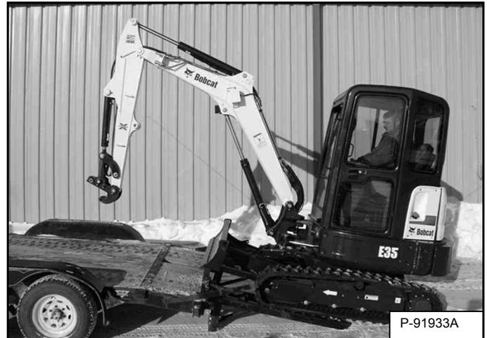
Die Maschine vorwärts auf das Transportfahrzeug fahren **[Abbildung 231]**.
