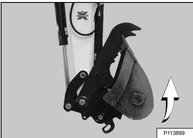
Das Anbaugerät etwas vom Boden abheben.
