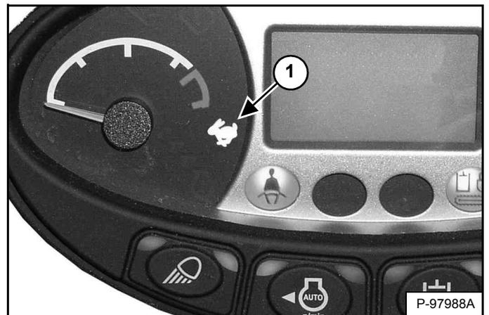
Wenn die hohe Fahrstufe aktiviert wird, leuchtet das Symbol für zwei Fahrstufen (1) [Abbildung 19] auf.
