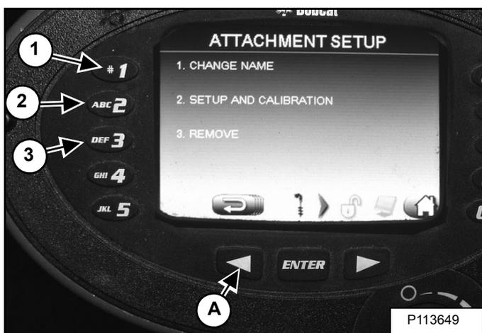
Auf dem Bildschirm [ATTACHMENT SETUP] kann [CHANGE NAME] (1) zur Namensänderung, [SETUP AND CALIBRATION] (2) zum Einrichten und Kalibrieren oder [REMOVE] (3) [Abbildung 184] zum Entfernen des Anbaugeräts aus der gespeicherten Liste ausgewählt werden.
