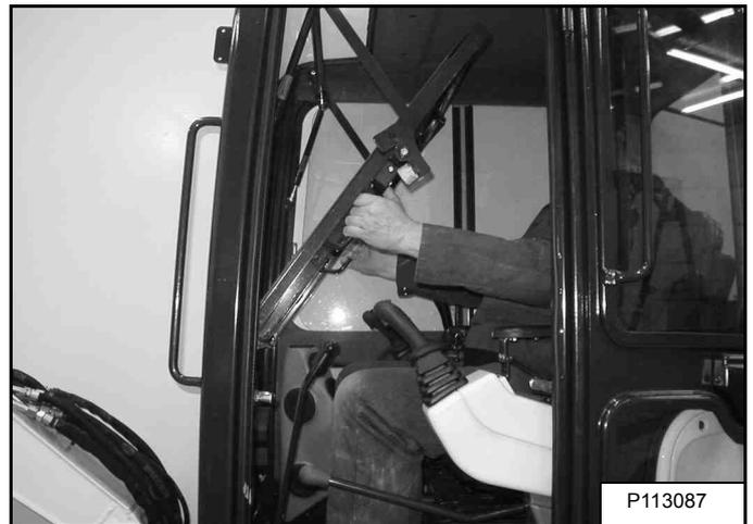
Öffnen Sie die Frontscheibe und steigen Sie aus [Abbildung 37].
