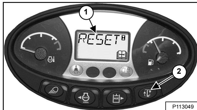
Drücken Sie die Informationstaste (2) [Abbildung 331], bis auf dem Anzeigebildschirm die Wartungsuhr angezeigt wird.
