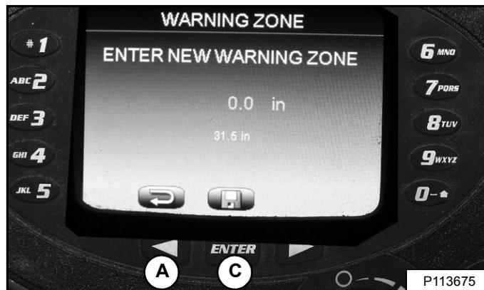
Die neue Abmessung des Warnbereichs über die Tastatur (1 bis 0) eingeben. Falls die Abmessung falsch eingegeben wurde, kann diese mit der Pfeiltaste nach links (A) [Abbildung 207] korrigiert werden.
