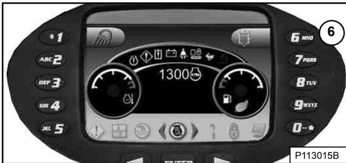
**HINWEIS:** Wenn die Zusatzhydraulik bei abgestelltem Motor aktiviert ist, bleibt sie auch aktiviert, wenn der Motor erneut gestartet wird. Wenn der kontinuierliche Durchfluss bei abgestelltem Motor aktiviert wurde, wird er in den ausgewählten Durchflussmodus zurückgesetzt.
