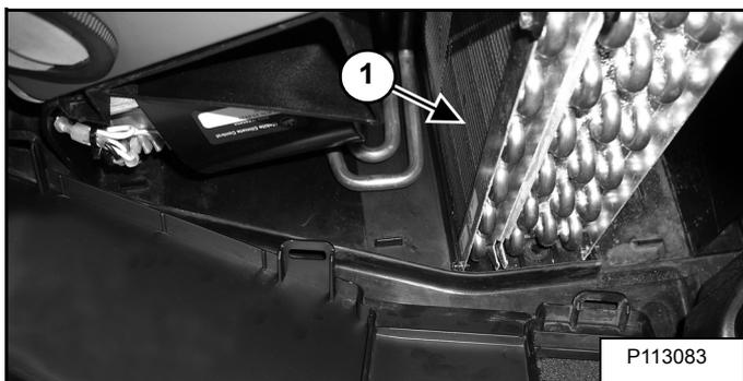
Mit Druckluft oder Wasser bei geringem Druck den Schmutz entfernen und die Spulen reinigen (1) [Abbildung 251].
