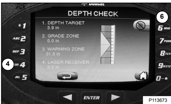
Die Taste (4) [Abbildung 209] für [LASER RECEIVER] drücken.
