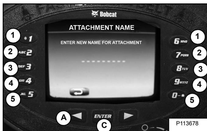
Über die Tasten der Tastatur (1 bis 0) einen Namen oder eine Zahl für das einzurichtende Anbaugerät eingeben. Die Taste [ENTER] (C) [Abbildung 185] drücken, um den Namen zu speichern. (Um den Namen einzugeben, die entsprechende Taste mehrmals drücken, bis der gewünschte Buchstabe oder die Zahl für den Namen des Anbaugeräts auf dem Bildschirm erscheint.)
