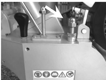
Bei korrekter Einstellung schleift das Schleifband gleichmäßig über die gesamte Breite der Schleifwalze. Andernfalls bitte wie folgt vorgehen:
