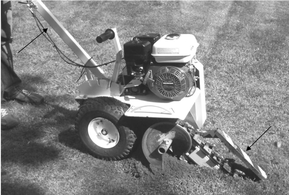
Erhöhen Sie die Motorgeschwindigkeit und senken Sie das Frässhwert.
