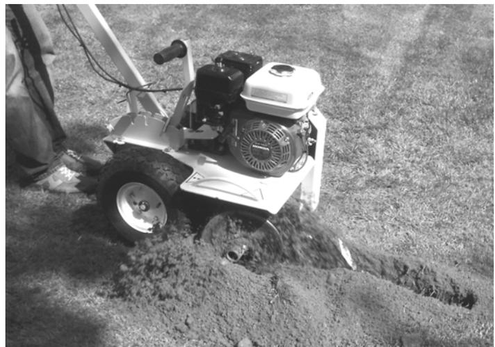
**ACHTUNG:** Wenn Sie in Bereichen fräsen, in denen es Hindernisse gibt, z.B. Steine und Schutt, bedienen Sie die Fräse auf vorsichtiger Drosselung, um eine schnellere Kupplungslösung zu gewährleisten. Dieses hilft, Schaden an der Maschine und eventuelle Verletzungen des Bedieners oder umstehende Personen zu verhindern.
